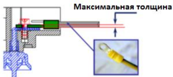
Рис. 11: Максимальная толщина концевой кабельной муфты
